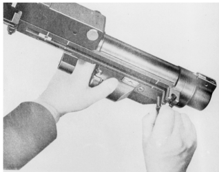
Abb. 79: EA, Federbolzen wird eingeschoben
