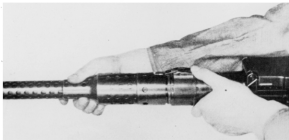
Abb. 68: Ausbau des Mantels mit Lauf
