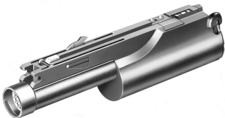
Abb. 21: Elektrische Durchladeeinrichtung (ED 131), (für Linksanbau vorbereitet)
