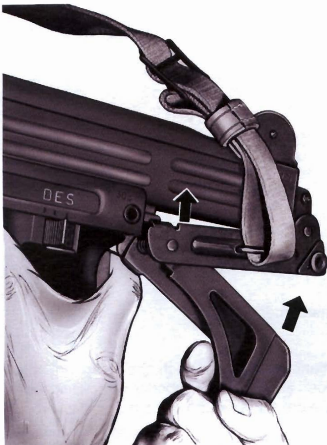
Bild 39 Gelenkschienen nach unten schwenken und an den Gehäuseboden anlegen
