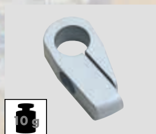
↑ Füllstück gross , für Hakenkappe 2213-8700, ca. 10 g, 39 mm lang, innen-Ø 11,9 mm. Ohne Schraube. Filling piece large , for hook butt plate 2213-8700, approx. 10 g, 39 mm long, inner Ø 11,9 mm. Without screw. Best.-Nr.: 003687
