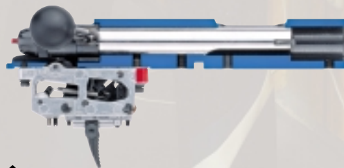
↑ Exzentrisch gelagertes Schloss in der Verschlusshülse. Eccentric bolt in the receiver.
